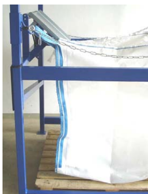
Abbildung BOP-Rack S1, Variante mit Tür und Rutsche
